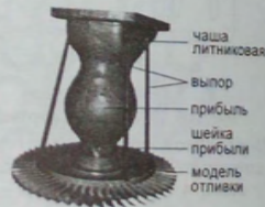
Рис. 3.9. Модельный блок отливки "Ротор" с ЛПС типа VI
