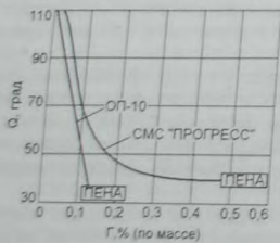
Рис. 6.12. Зависимость краевого угла смачивания модельного состава КПСЦ от содержания ПАВ в жидкостекольной суспензии
