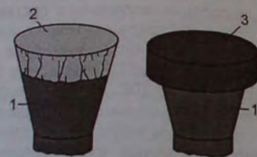
Рис. 6.58. Схемы заклейки ЛВ (1) бумагой (2) и установки на ЛВ колпачка (3)
