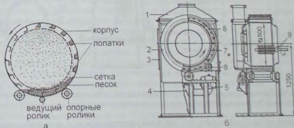
Рис. 6.38. Принципиальная схема (а) и общий вид (б) барабанной установки элеваторного типа: 1 – зонт вытяжной, 2 – барабан, 3 – каркас, 4 – редуктор понижающий, 5 – электродвигатель, 6 – ролик, 7 – сетка, 8 – лопатка, 9 – модельный блок
