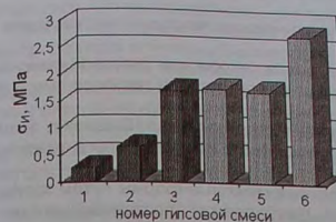
Рис. 6.74. Предел прочности при статическом изгибе затвердевших гипсовых масс после предварительного прокаливания при 600^\circ\text{C} в течение 3 ч
