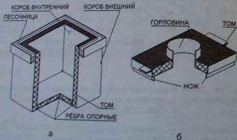
Рис. 7.19. Общий вид короба (а) и крышки (б) термостата
