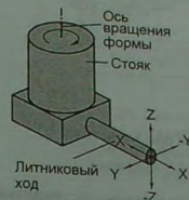
Рис. 11.16. Направления движения расплава в отливке при центробежной заливке формы с вертикальной осью вращения
