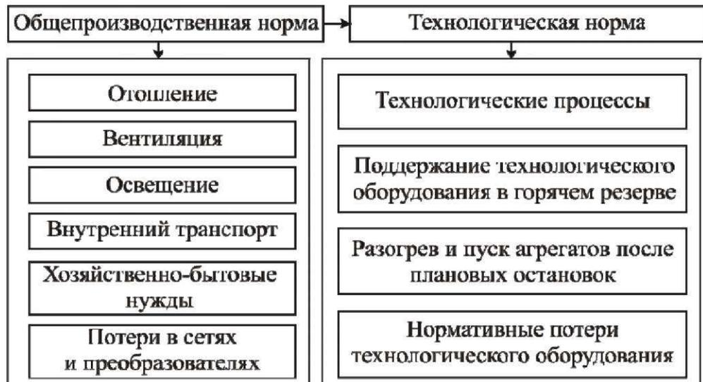
Рис. 3.2. Примерный состав технологической и общепроизводственной норм расхода ТЭР
