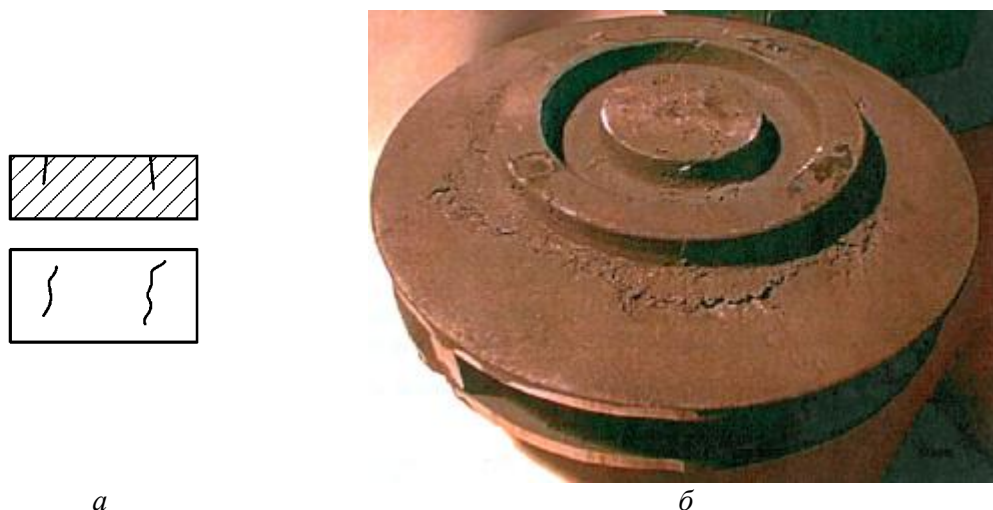
Рис. 79. Дефект – горячая трещина: а – схема; б – дефектная отливка
