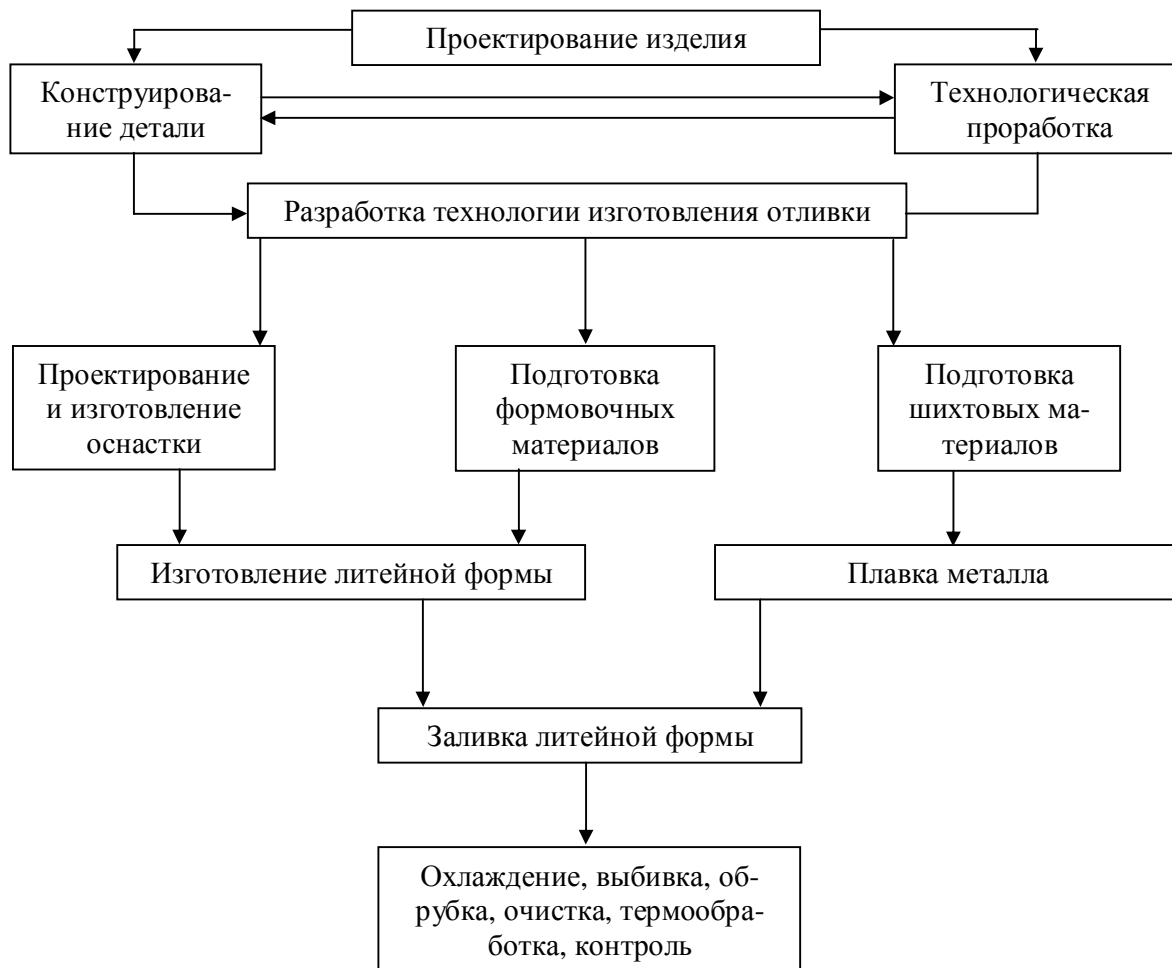
Рис. 5. Схема технологического процесса изготовления отливки
