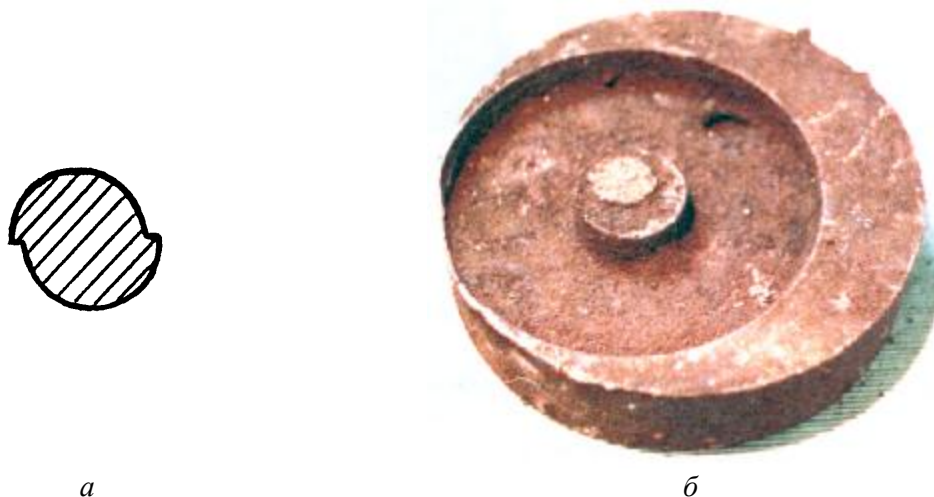
Рис. 71. Дефект – перекося: а – схема; б – дефектная отливка
