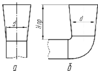
Рис. 162. Типы открытых прибылей: а – прибыль прямого питания; б – прибыль бокового питания
