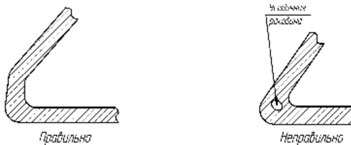
Рис. 123. Сопряжение стенок отливки
