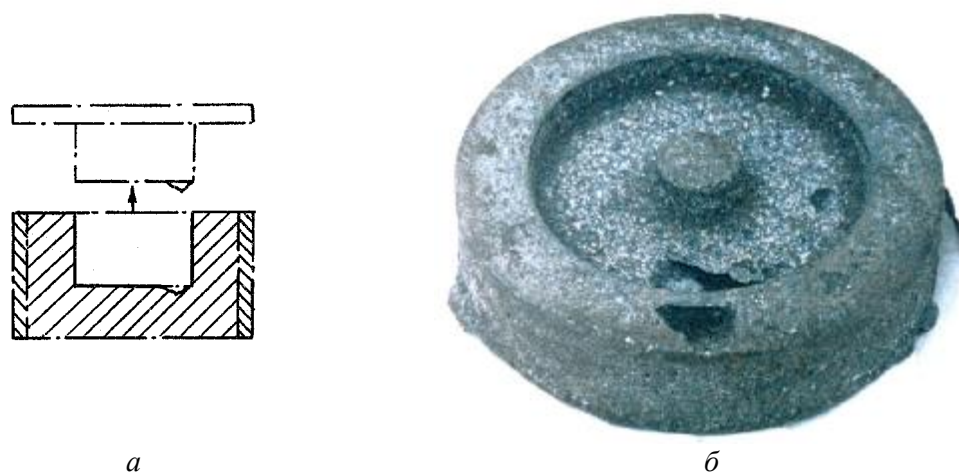
Рис. 78. Дефект – нарост: а – схема; б – дефектная отливка
