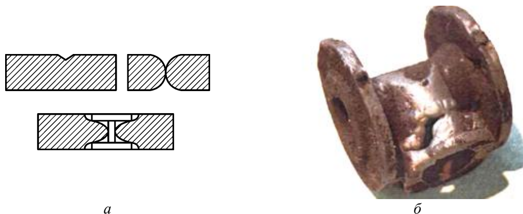
Рис. 70. Дефект – неслитина: а – схема; б – дефектная отливка
