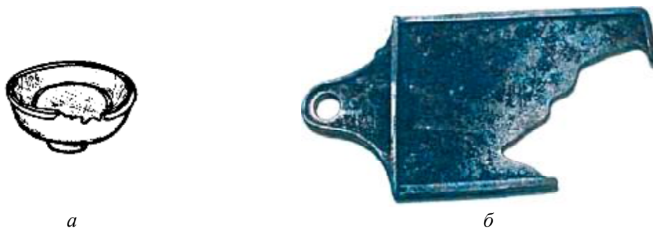
Рис. 69. Недолив в результате недостаточной жидкотекучести (холодный металл) a – схема; б – дефектная отливка
