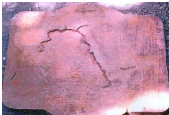
Рис. 77. Дефект – ужимина: а – схема; б – дефектная отливка
