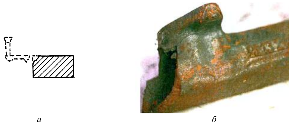
Рис. 75. Дефект – вылом: a – схема; б – дефектная отливка
