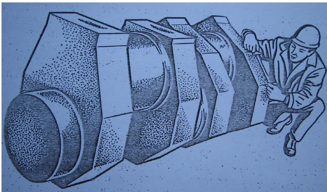
Рис. 6.18. Отливка, полученная по технологии ЭШЛ.
