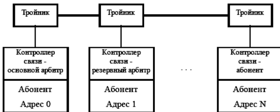
Рис. 4.7. Структурная схема магистрали МАПС
