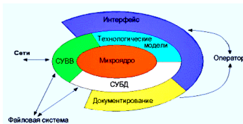
Рис.4.3. Структура системы реального времени ТкА
