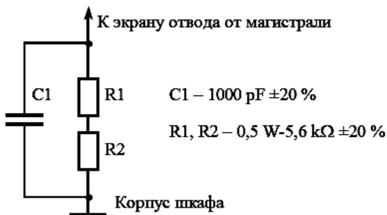
Рис. 4.8. Схема подключения экрана отвода к шкафу
