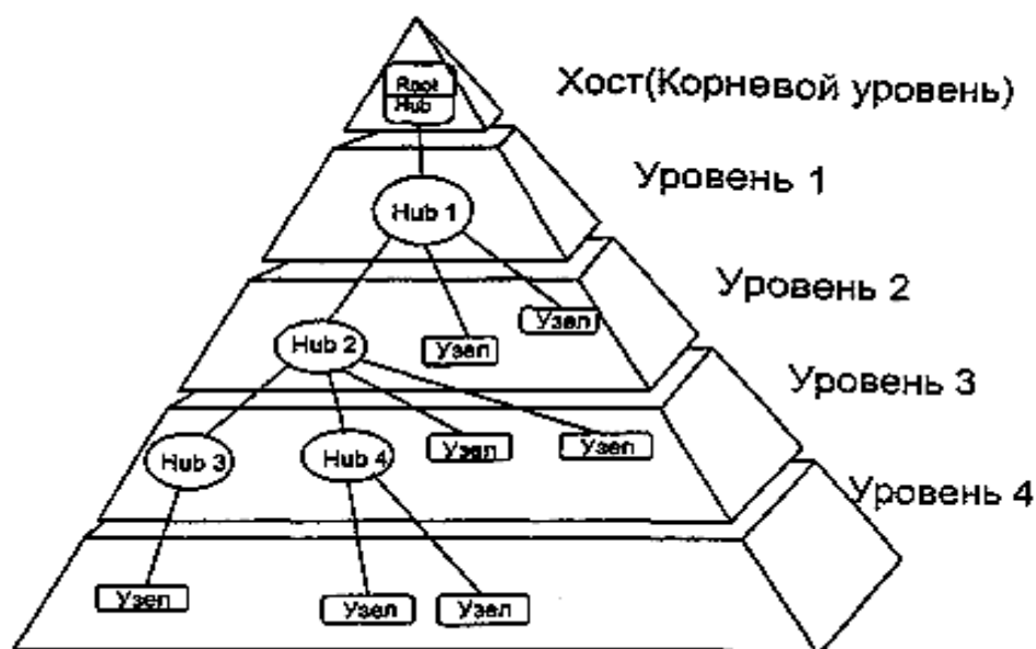
Рис. 3.10. Топология шины USB
