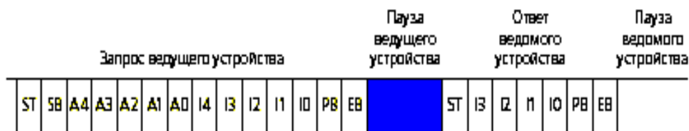
Рис. 2.4. Структура протокола AS-интерфейса
