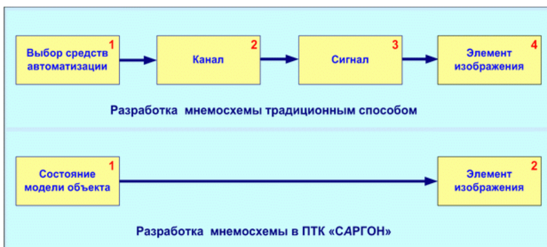
Рис.4.4. Этапы разработки мнемосхем
