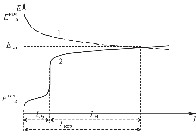
Рис. 9.3. Поляризационная диаграмма коррозии при R \approx 0 : 1 — парциальная анодная кривая; 2 — парциальная катодная кривая
