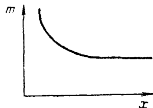
Рис. 147. Диффузионный поток m на различных расстояниях x от края пластинки
