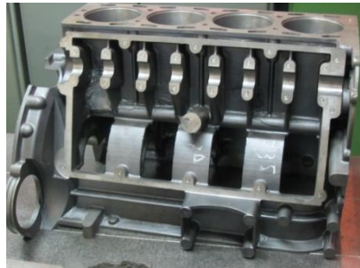
Рисунок 6.1. Блок цилиндров: а – Quick-Cast-модель; б – чугунная отливка.
