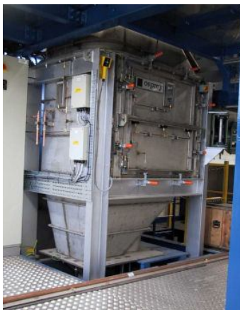
Рисунок 7.21. Установка «Spray forming»: емкость до 80 кг по Al. Оксфордский университет
