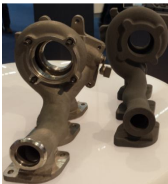
Рисунок 6.6. Полистирольная модель и отливка детали двигателя
