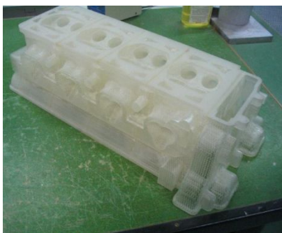
Рисунок 6.12. Quick-Cast модель: а – после выращивания; б – оснащенная литниковой системой
