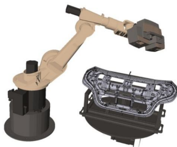
Рисунок 6.45. Роботизированный модуль «Контроль геометрии» на базе фотограмметрической системы ATOS Triple Scan
