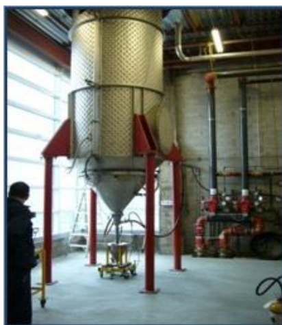
Рисунок 7.4. Технология Plasma Atomization: а – схема процесса плазменной атомизации; б – атомайзер Raymor [21]
