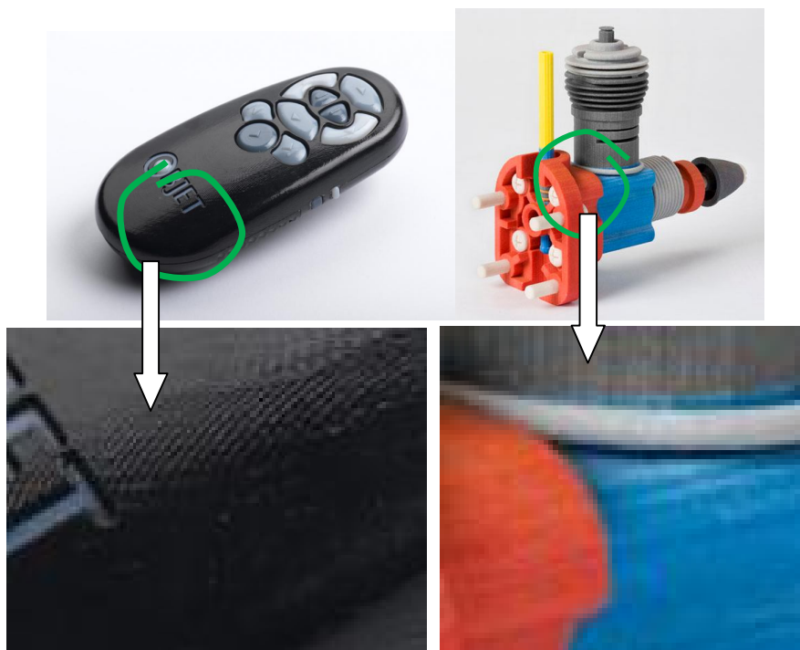
Рисунок 4.4. Прототипы, созданные на принтерах Eden 250 и ProJet® 660 а – Прототип пульта (Objet Eden 250) б – Модель сборочного узла (ProJet® 660)
