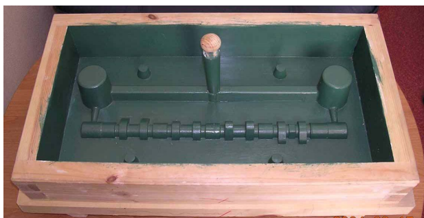
Рисунок 6.10. Полиамидная модель: SLS-модель распределительного вала и формовочный ящик
