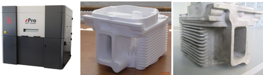
Рисунок 6.4. SLS-машина sPro 60 (а); полистирольная модель (б); и алюминиевая отливка головки цилиндра ДВС (в)
