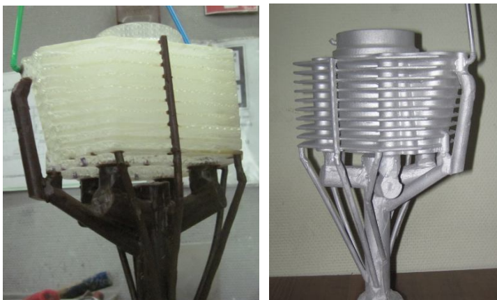
Рисунок 6.14. Quick-cast-модель с литниковой системой и алюминиевая отливка цилиндра ДВС
