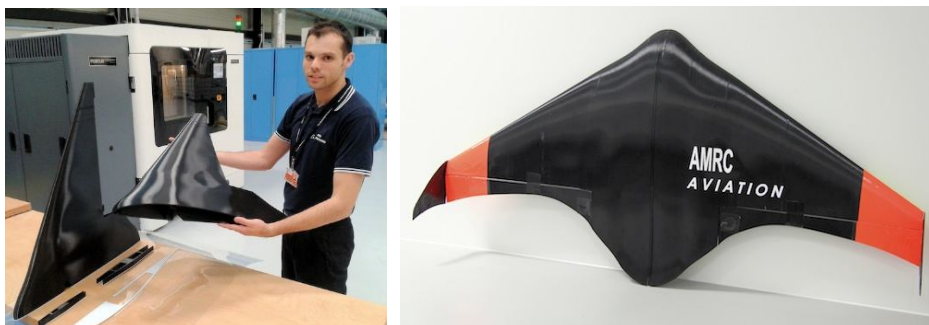
Рисунок 3.6. Беспилотный ЛА, построенный по АМ-технологиям
