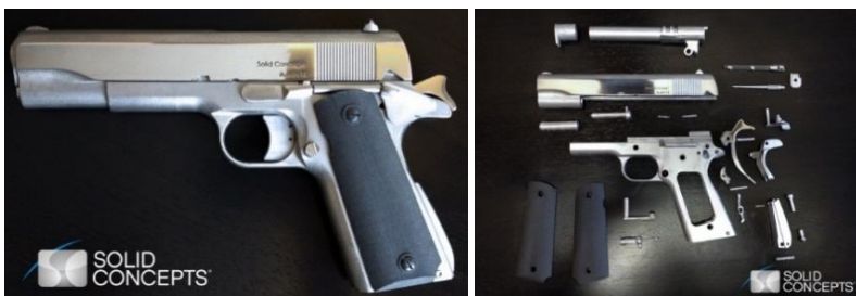
Рисунок А6 – Первый в мире пистолет (45ACP), все детали которого, включая нарезной ствол, построены на 3D-принтере по технологии DMLS (компания Solid Concept, [40])
