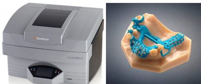
Рисунок 2.10. Принтер CrownWorx: зона построения XYZ=152,4x152,4x50,8 мм; толщина слоя 50 мкм. Технология WDM
