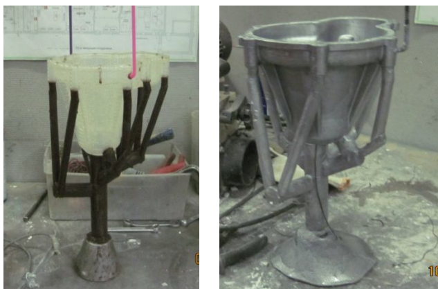
Рисунок 6.14. Quick-cast-модель с литниковой системой и алюминиевая отливка цилиндра ДВС
