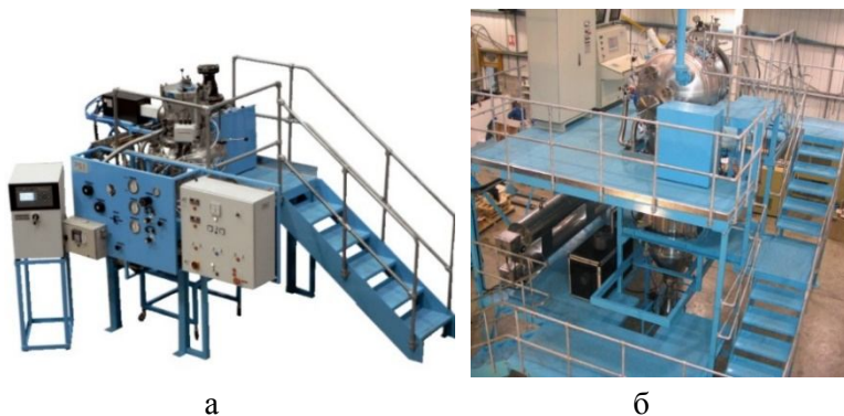
Рисунок 7.26. Атомизеры PSI: а – Hermiga 75/3; б – Hermiga 100/10 VI
