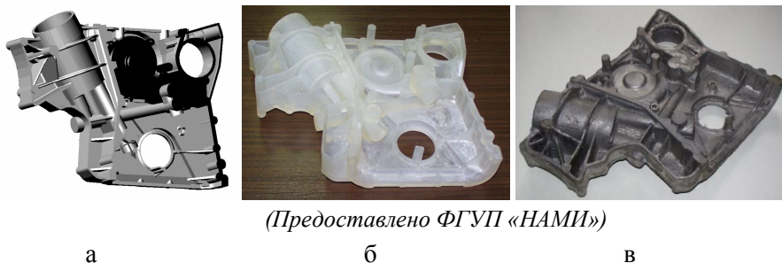
Рисунок 6.19. Передняя крышка ДВС: а – CAD-модель, б – SLA-модель в качестве формовочной модели; в – алюминиевая отливка «в землю»
