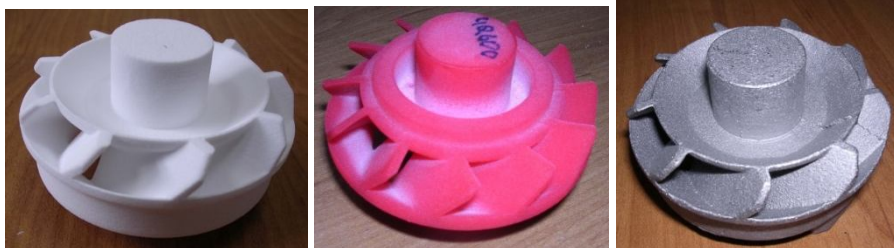
Рисунок 6.5. Полистирольная модель: а – после «выращивания»; б – после инфильтрации; в – чугунная отливка
