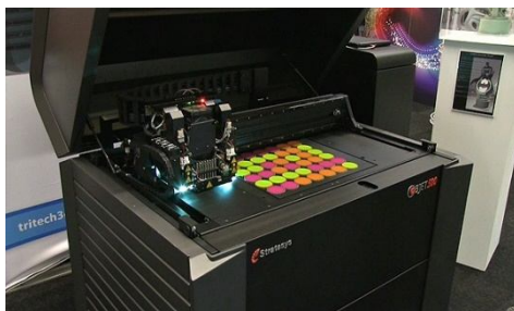
Рисунок 2.8. Принтер Objet500 Connex3: зона построения XYZ=490 × 390 × 200 мм; шаг построения 0,016-0,030 мм
