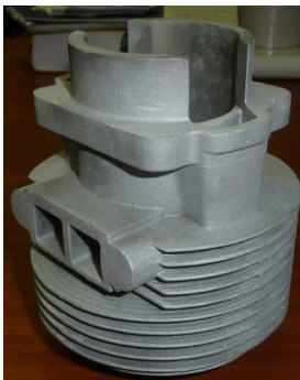
Рисунок 6.17. Получение отливок с использованием SLA-мастер-модели: а – мастер-модель (SLA); б – силиконовая форма; в – восковая модель; г – отливка
