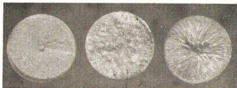
Фиг. 80. Изменение структуры сплава в изломе в зависимости от температуры заливки. Плавка А.
