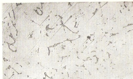
Фиг. 34. Структура аустенитной стали типа 18-8, содержащей титан и закаленной с 1100^\circ в воде ( \times 100 ).
