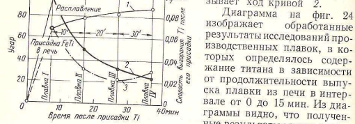
Фиг. 23. Угар титана в лабораторной печи с основной футеровкой (присадка 0,75% Ti):
