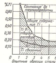
Фиг. 37. Распределение титана между фазами в термически не обработанных сталях 1—6 (табл. 9).
