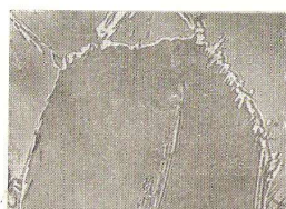
Фиг. 50. Выделения карбидов в виде точек по границам зерен (увеличено в 300 раз; специальный травитель).
