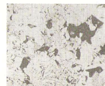
Фиг. 73. Микроструктура металла отливки из феррохрома (Паулинг).
