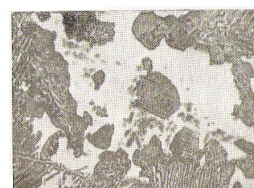
Фиг. 53. Округленные ракушечнообразные зерна троостита (×200; специальный травитель).
