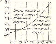
Фиг. 10. Влияние углерода и титана на стойкость аустенитных хромоникелевых сталей против межкристаллитной коррозии (по Шаффмейстеру).
