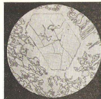
Фиг. 87. Структура эвтектического хромистого сплава (измельченные карбиды): 3,16% С; 30,5% Сг ( \times 500 ; специальный травитель).
