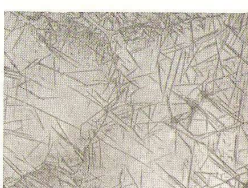
Фиг. 51. Выделения карбидов в виде игл (×300; специальный травитель).
