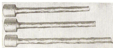
Фиг. 17. Поверхность образцов аустенитной стали после разрыва при испытаниях на растяжение.
