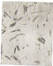
Фиг. 108. Структура сплава, содержащего 27% Al; основная его составляющая — \beta -фаза с выделенными карбидами и графитом.
