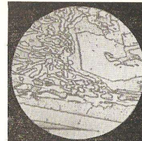
Фиг. 88. Структура эвтектического хромистого сплава (измельченные карбиды): 3,16% С; 30,5% Сг ( \times 600 ; азотная кислота).
