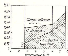
Фиг. 36. Распределение титана между фазами в сталях 10, 11 и 12.
