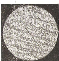
Фиг. 56. Структура стали, показанная на фиг. 55, но отпущенная при 400° (×150; пикриновая кислота).
