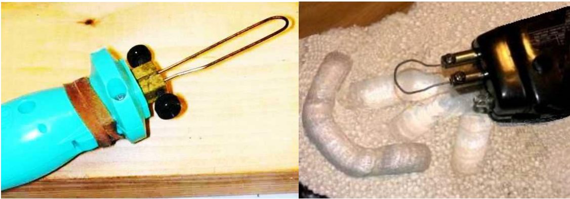
Рис. 2. Пропалювачі і виконані ними округлі канали в пінопласті
