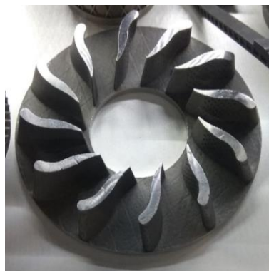
Рис. 2. Загальний вигляд колеса турбіни, виготовленого за SLM-технологією
