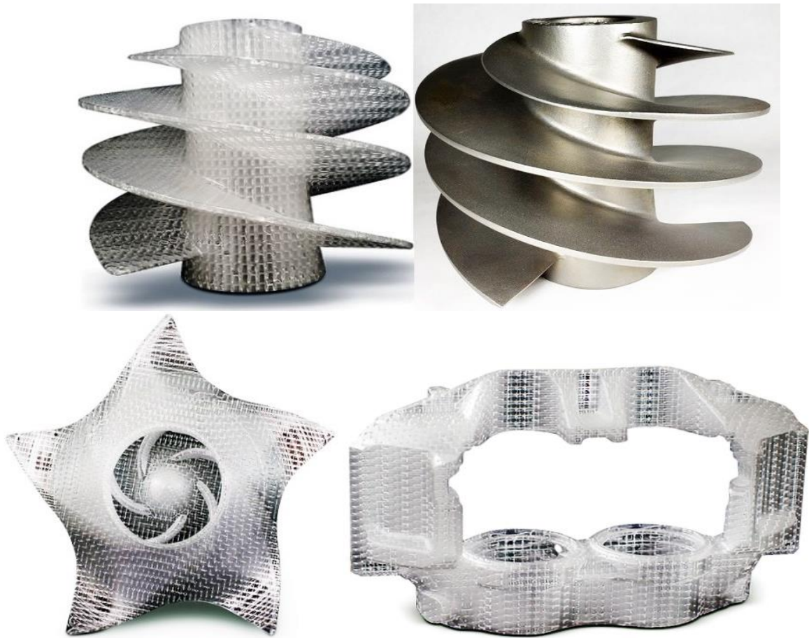
Рис. 1. Приклади моделей, отриманих АВ, та виливка по одній з них
