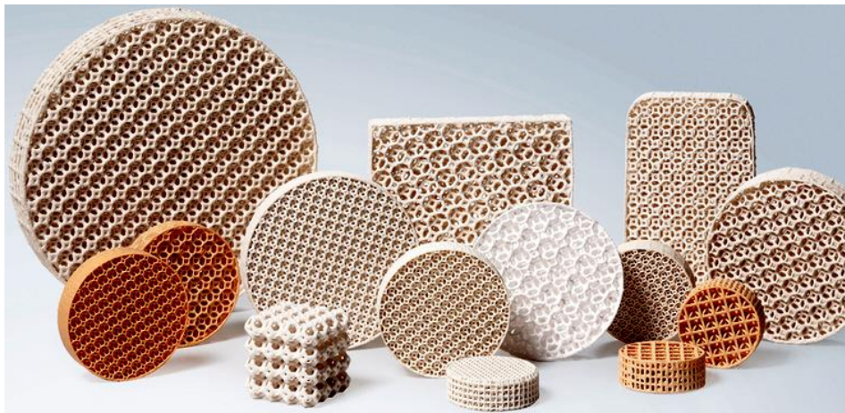
Рис. 1. 3D-друковані фільтри з контрольованою «геометрією» пор [1]
