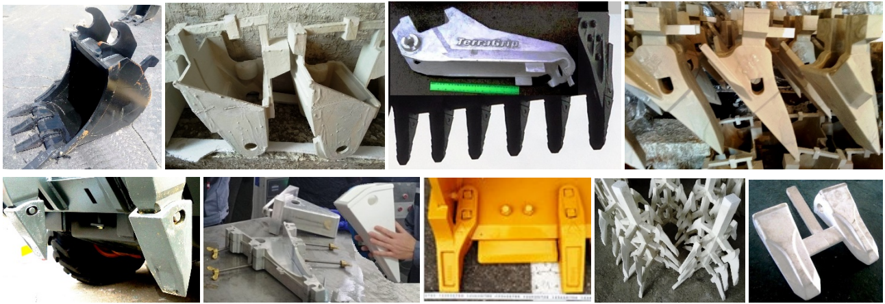
Рис. 3. Приклади литих деталей землерийної техніки і моделей для ЛГМ
