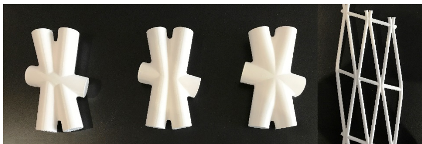
Рис. 6. Моделі вузлів різних конфігурацій та модульної конструкції
