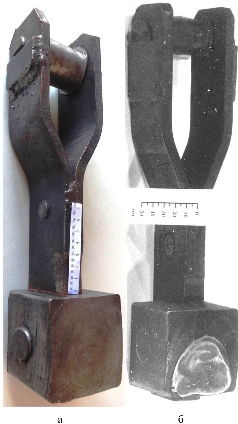
Рис. 1. Молоток до експлуатації (а) і після напрацювання 150 \times 10^3 ударних циклів (б)
