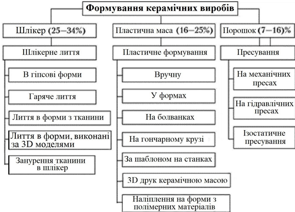
Рис. 2. Схема видів формування керамічних виробів [1]
