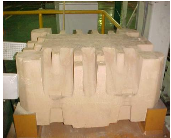
GMBond - стрижень вилки «Кришка блоку циліндрів» масою 104 кг, що виготовляється з алюмінієвого сплаву [155]
