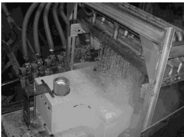
Процес руйнування ливарної форми за АС - процесом [311]
