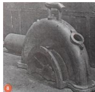
Корпус відцентрового насоса масою 480 кг.
