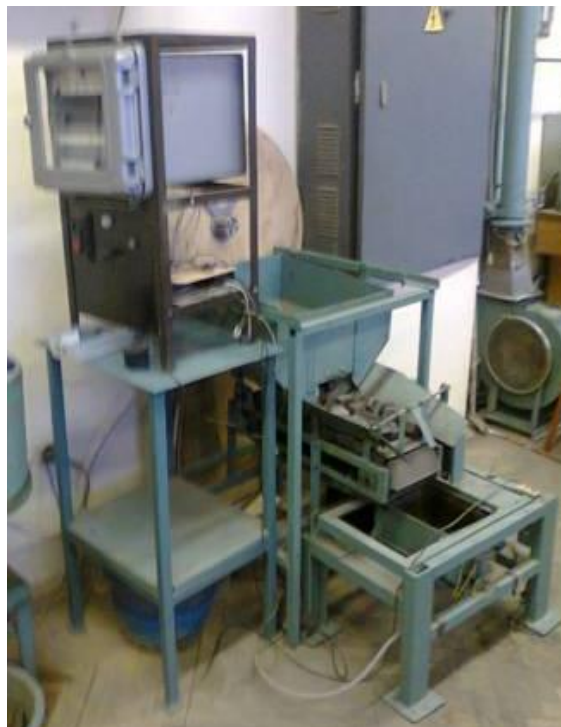
Модель системи дозування шихти для вагранки, що була розроблена ІПЛ АН УРСР. Лабораторія кафедри ливарного виробництва НТУУ (КПІ).
