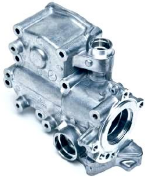
3-й приз виставки. Виливок «Корпус коробки передач вантажівки», сплав AC-Al Si10Mg(Fe), розміри 250x170x115 мм, вага 1785 гр. [253]
