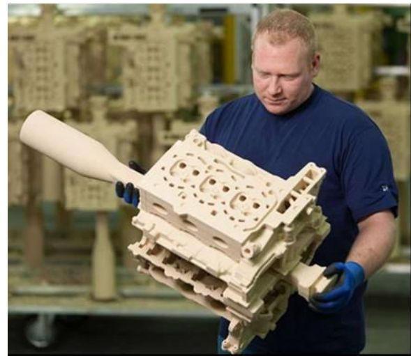
Ливарний піщаний стрижень на ливарному заводі BMW Landshut, Німеччина [251]
