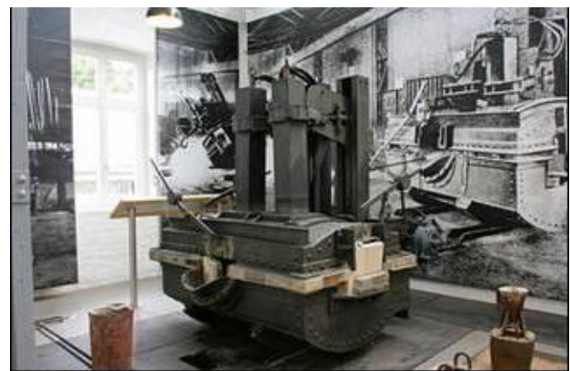
Плавильна піч конструкції П. Еру, 1905р. Експонат Німецького музею інструментів, м. Ремшайд [22]
