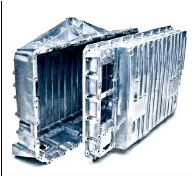
2-й приз виставки. Виливок «Корпус батареї автомобіля», сплав Al Si10MnMg, розміри 781x508x115 мм (верхня частина) і 774x581x177 мм (нижня частина), вага 6400 гр. (верхня частина) і 9140 гр. (нижня частина) [253]
