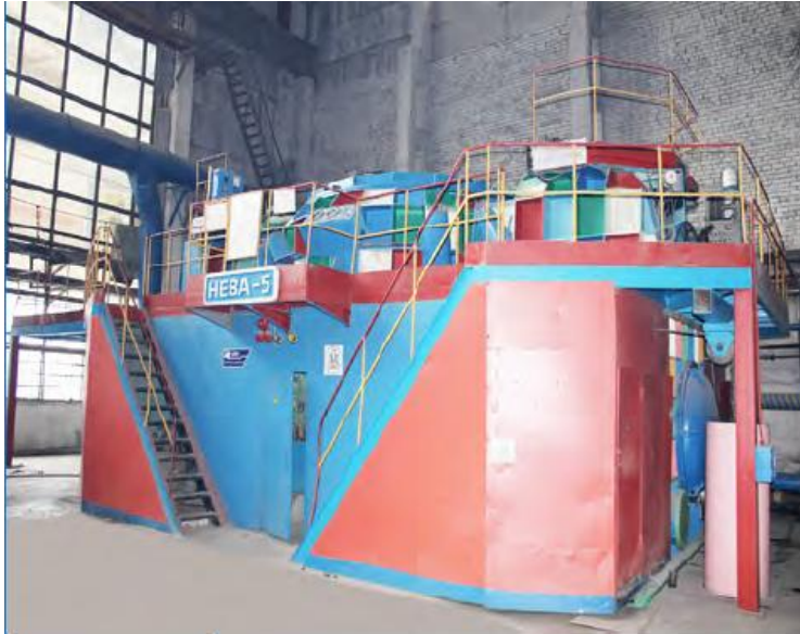
Вакуумна плавильно-заливальна гарнісажна двотигельна піч «Нева-5» на Зеленодольському суднобудівному заводі, Росія [209]
