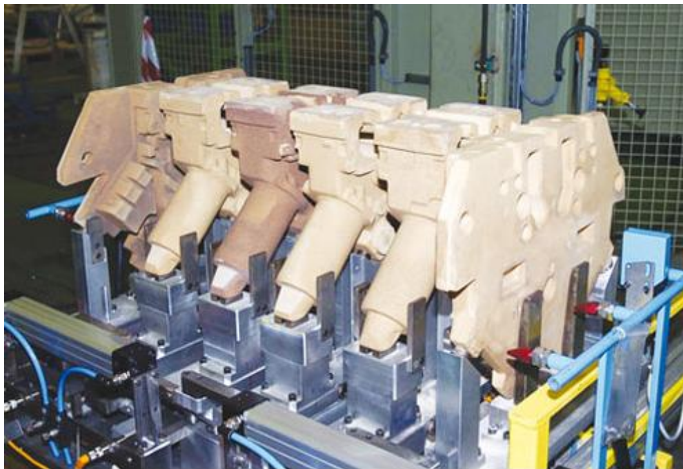
Система точної фіксації стрижнів Loramendi Key Core [148]
