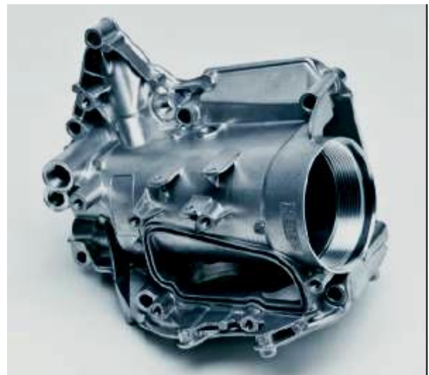
1-й приз виставки. Виливок «Частина модуля масляного охолодження двигуна», сплав Al Si9Cu3(Fe), розміри 254x220x303 мм, вага 3996 гр. [253]
