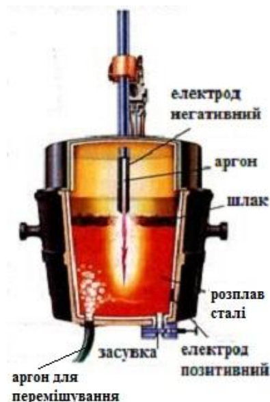
Схема ливарного ківша з плазмотроном [150]
