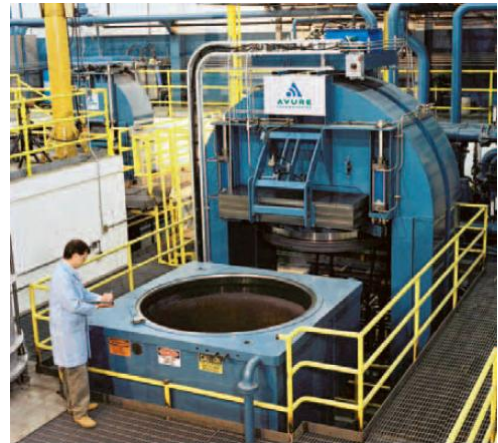
Прес Quintus для ГІП від компанії Avure Technologies, м. Кент, США. Забезпечує тиск 103МПа при максимальній температурі 1260 °С. Внутрішній діаметр печі 1,7м, висота 2,5 м [211]
