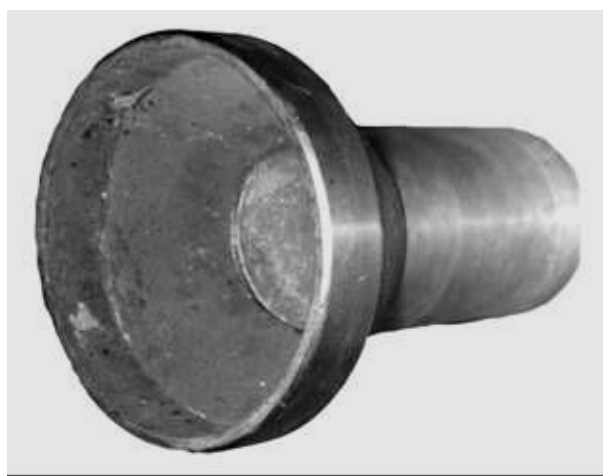
Відливка насадки пальника котлоагрегата ТЕС з хромоалюмінієвої сталі [154]
