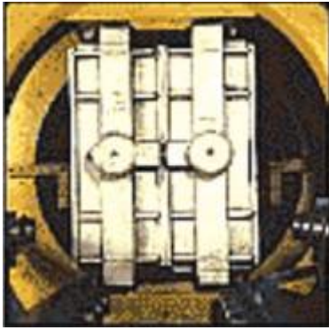
Кантувальний пристрій для ливарних форм на лінії HWS [215]
