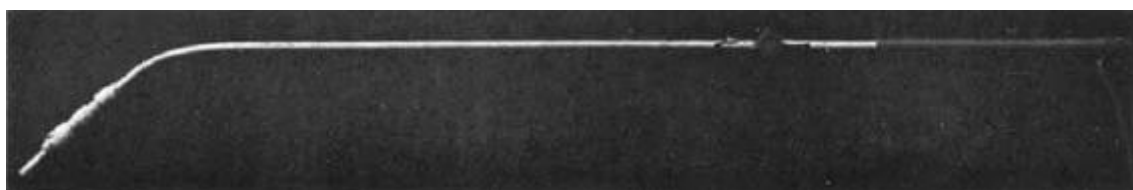
Типова термопара для вимірювання температури в електроплавильних печах [141]
