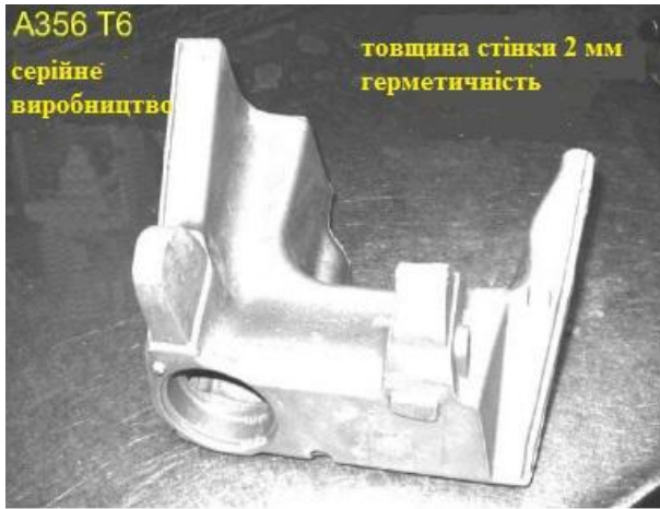
Виливка паливного баку з кронштейном для кріплення з сплаву А356 (Al-Mg) з товщиною стінки 2мм, заміна зварюваного виробу
