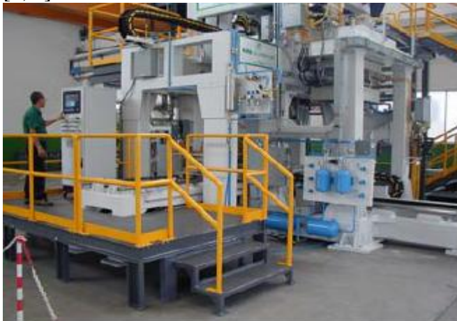
Ливарна піскострільна GMBond - стрижнева машина, створена та виготовлена FATA Aluminium, Турин, Італія [155]
