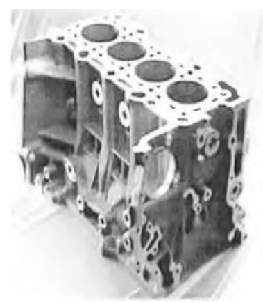
Тиксолитий автомобільний блок циліндрів [127]
