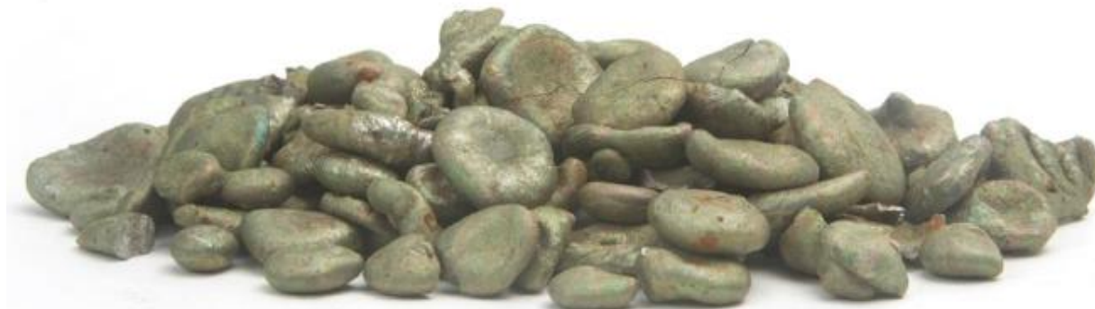
Гранулят феррохрому виготовлений за технологією Granshot [222]
