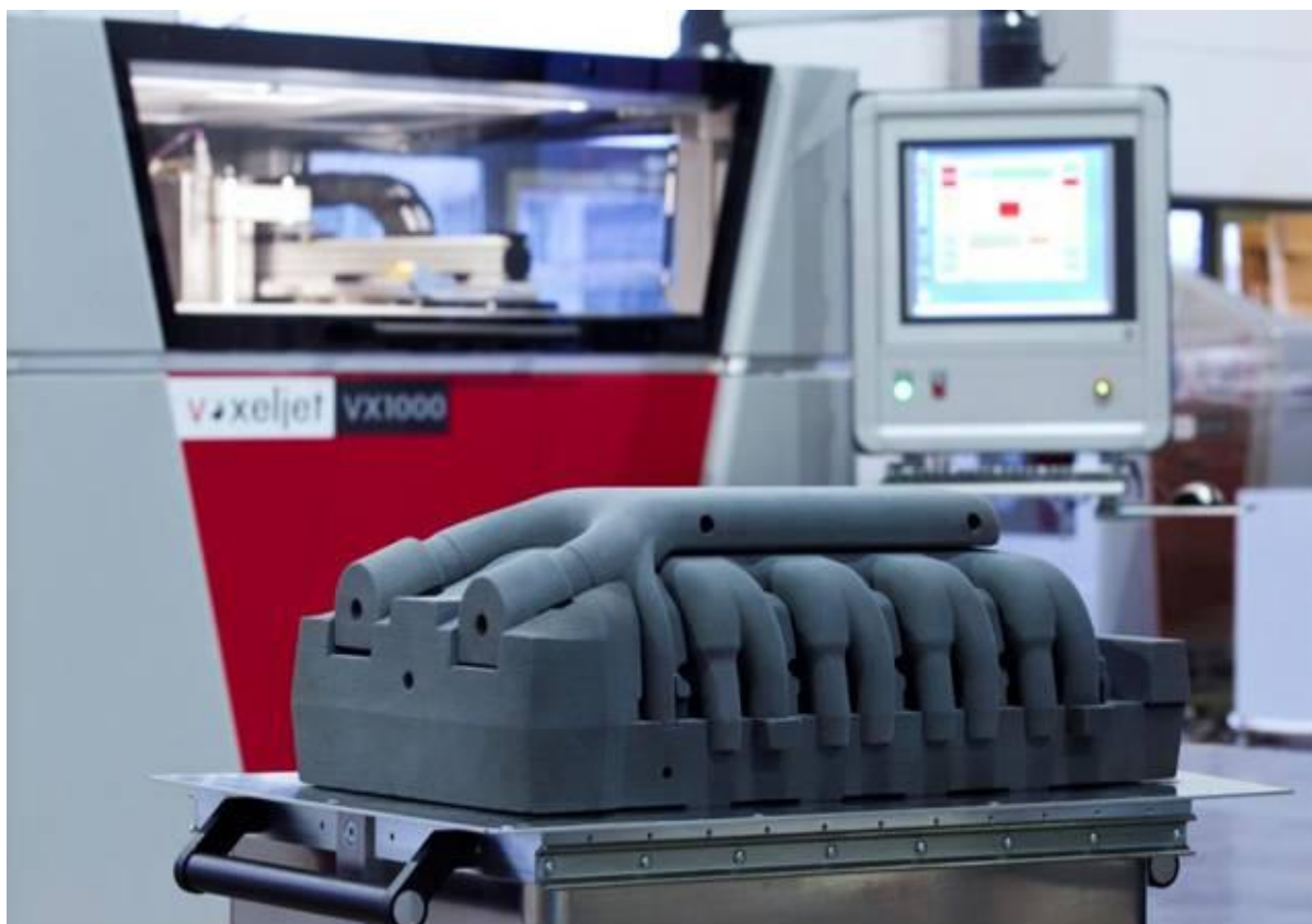
Ливарна стрижньова система виготовлена на 3-D принтері марки VX2000 компанії Voxeljet, Німеччина
