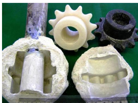
Шестерня: вилівка, заморожена модель і ливарна оболонкова форма (фото з архіву В. С. Дорошенка)
