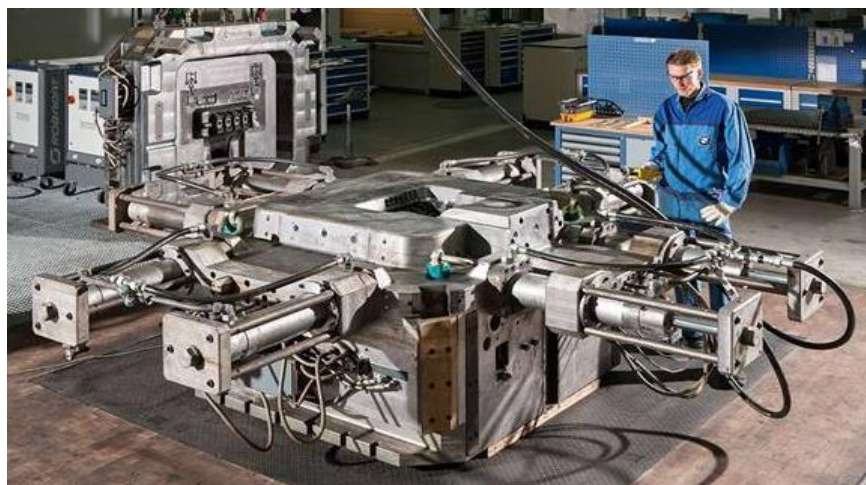
Кокільна установка на ливарному заводі BMW Landshut, Німеччина [251]
