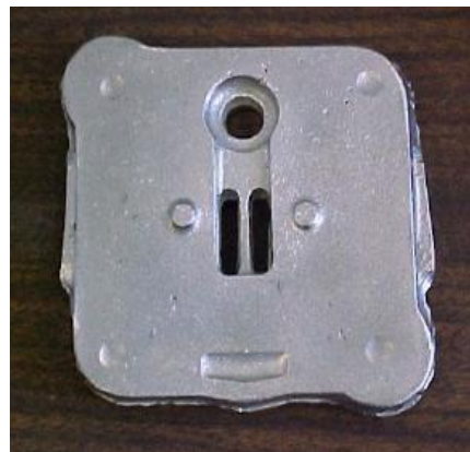
Перша вилівка «Клапанна плита» з магнієвого сплаву AZ91E, що виготовлена за вакуумно-плівковою технологією в США [161]
