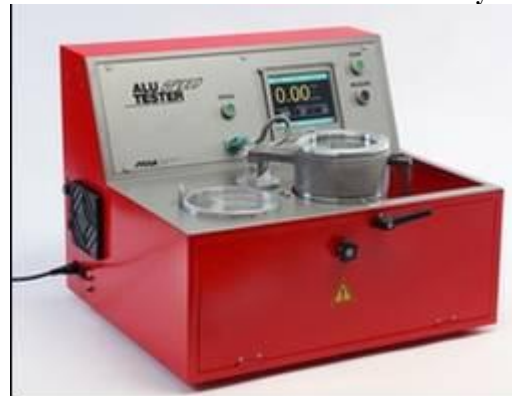
Сучасна установка для визначення вмісту водню в легких сплавах за методом Дардела ALUSPEED TES [137]
