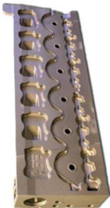
Виливок «Головка блоку циліндрів» виготовлена за технологією FPC – process [245]
