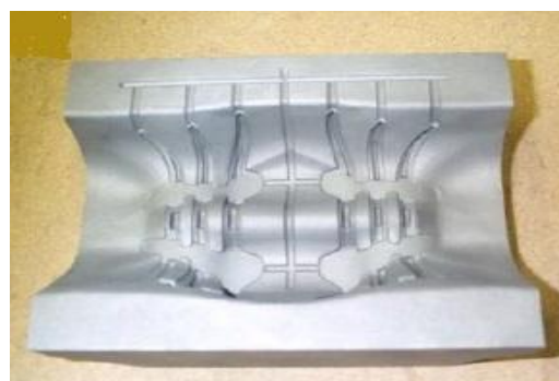
Вставка пластикой взугтевої форми, що виготовлена за технологією Sray Forming з сталі P20 (Fe-C-Cr-Mn-Mo) [202]
