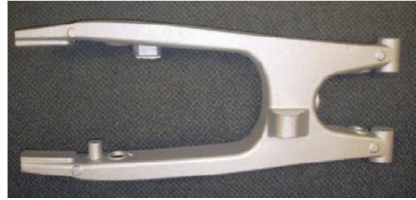
Виливка кронштейна з алюмінієвого сплаву В206 (Al-4,5Cu), товщина стінки 2,5 мм, без гарячих тріщин
