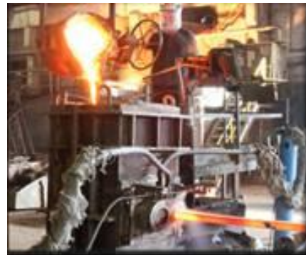
Лінія безперервного горизонтально лиття чавунних заготовок марки ЛНЛЧ-3 на Липецькому виробничому комплексі «Новолит» [ http://www.lpknovolit.ru ]
