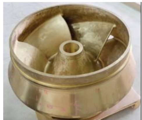
Виливок «Робоче колесо насоса» діаметром 1270 мм і вагою 900 кг. Виготовлено з бронзи за технологією 3D Sand Mold Printing and Casting компанії ExOne. Призначено для ремонтних робіт і зроблено в одному екземплярі.
