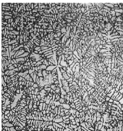
Дендритна структура литого Al-Si сплаву [127]
