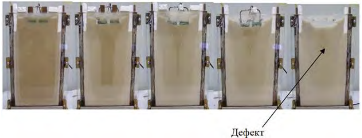
Рис. 2. Кристалізація зливка з обігріванням надливної частини
