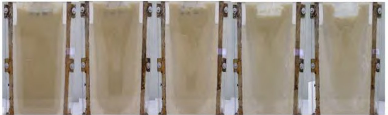
Рис. 3. Вплив обігрівання та перемішування на формування зливка
