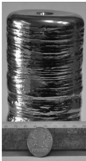
Рис. 6. Зовнішній вигляд кристалу вольфраму діаметром 85 мм
