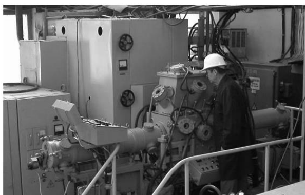
Рис. 2 Установа для вирощування монокристалів тугоплавких металів у вигляді пластин
