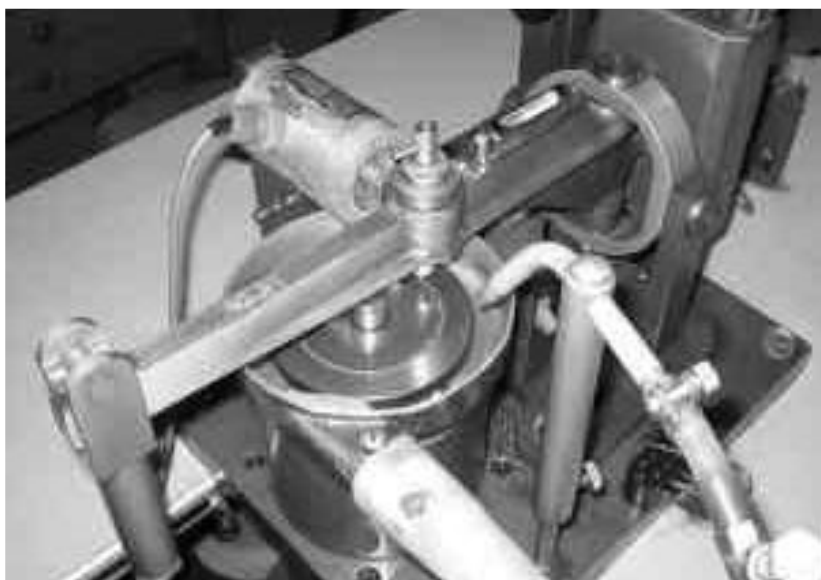
Рис. 2. Експериментальна установка для дослідження коефіцієнту тертя за схемою торцевого тертя
