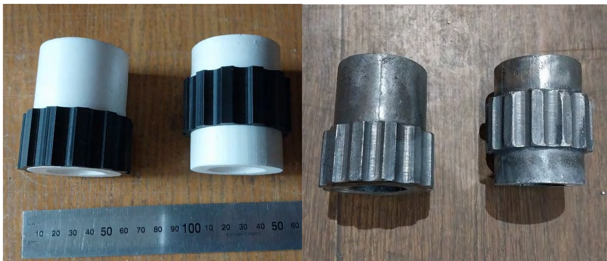
Рис. 1. Комбіновані полімерні моделі (а) та дослідні виливки (б)
