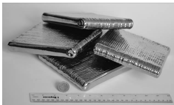
Рис. 3. Зовнішній вигляд плоских монокристалів вольфраму 170x160x20 мм
