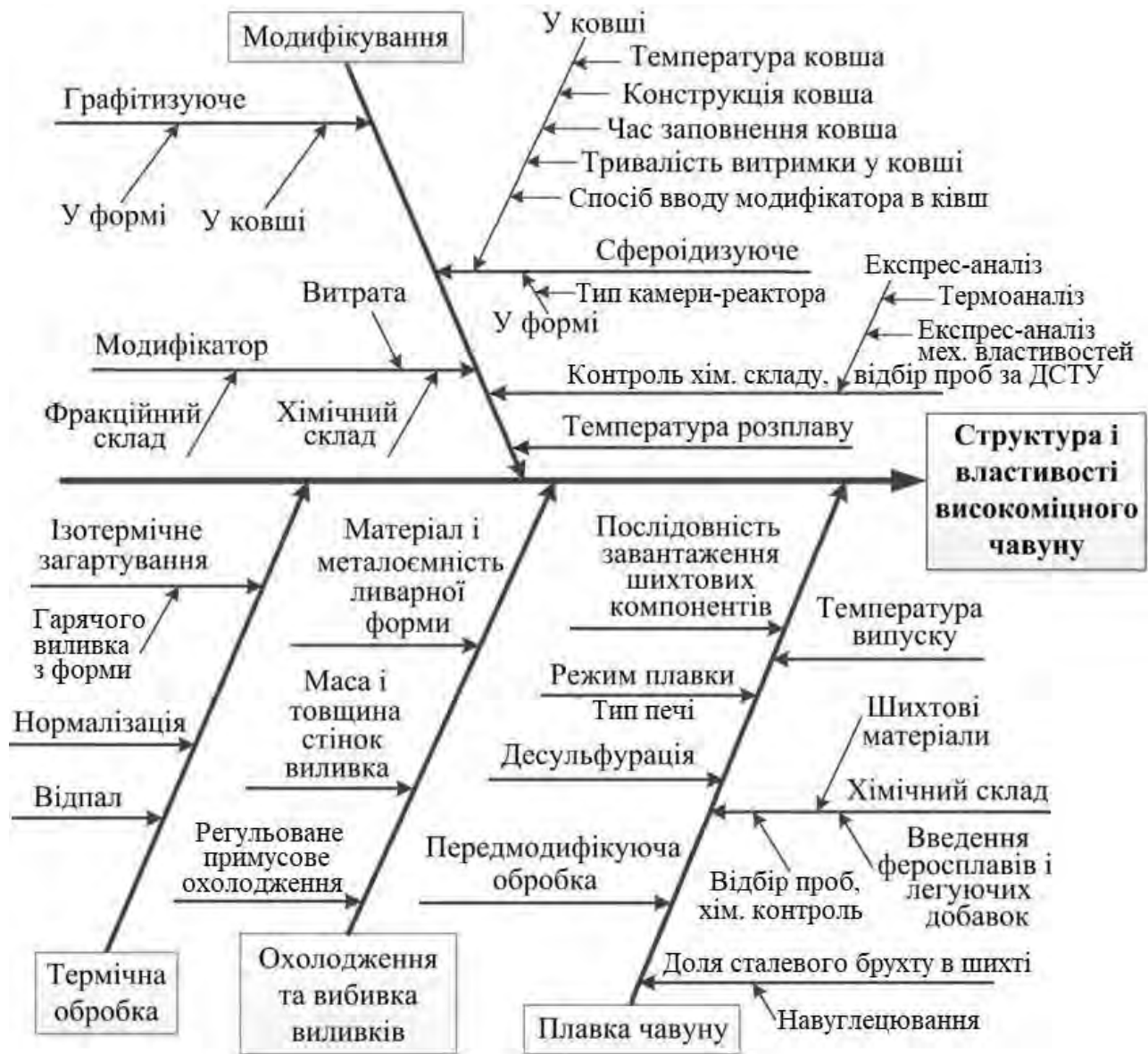
Рис. 1. Діаграма Ішікави для процесу виробництва виливків з ВЧ
