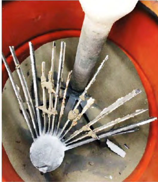
Рис. 1. Виливок з пробами за ЛГМ-процесом перед видаленням покриття
