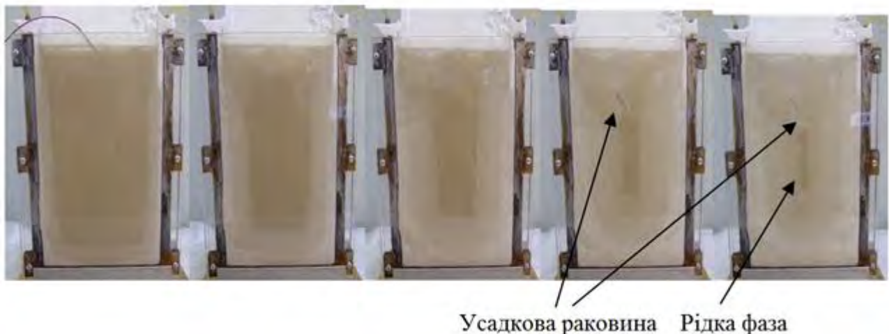
Рис. 1. Зміна об'єму рідкої фази в процесі кристалізації без підігріву
