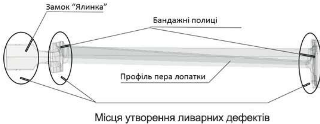
Рисунок 1. Місця утворення ливарних дефектів у виливку «Робоча лопатка»
