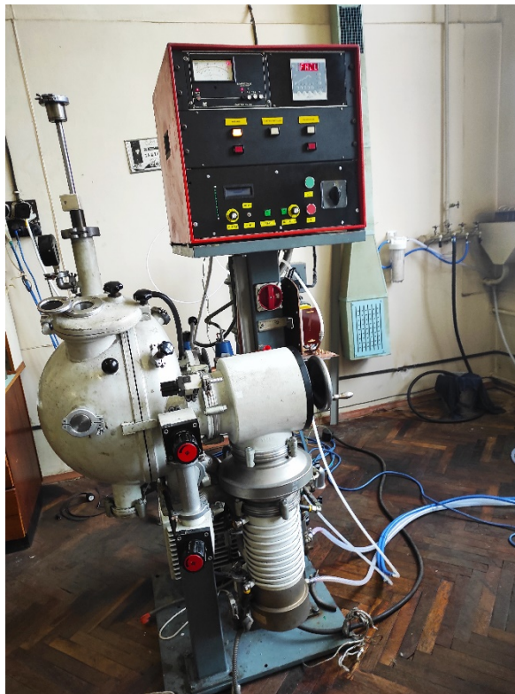
Рисунок 1. Фотографія розробленої та виготовленої вакуумної індукційної печі для виплавки виливків із високоентропійних сплавів
