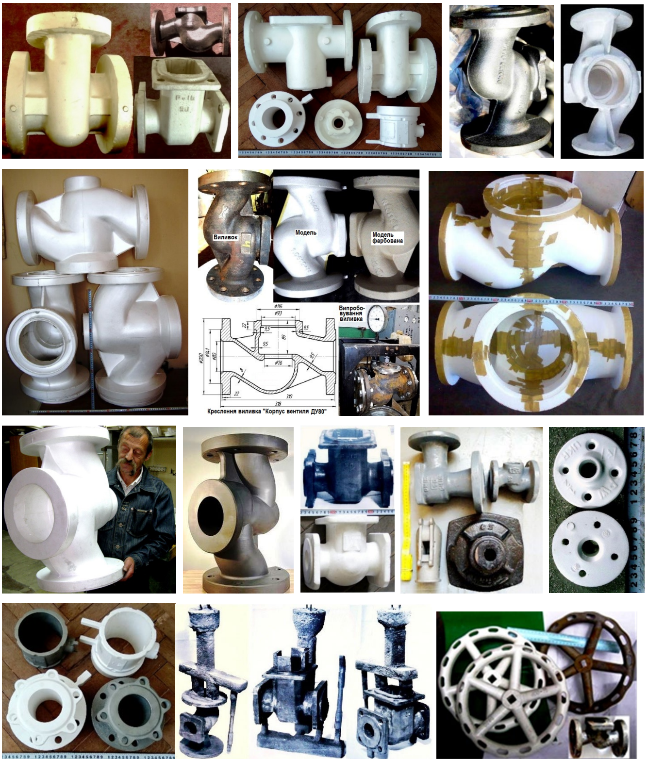
Рисунок 1. Ливарні моделі та виливки деталей трубої арматури з ливарного цеху ФТІМС НАН України [3]
