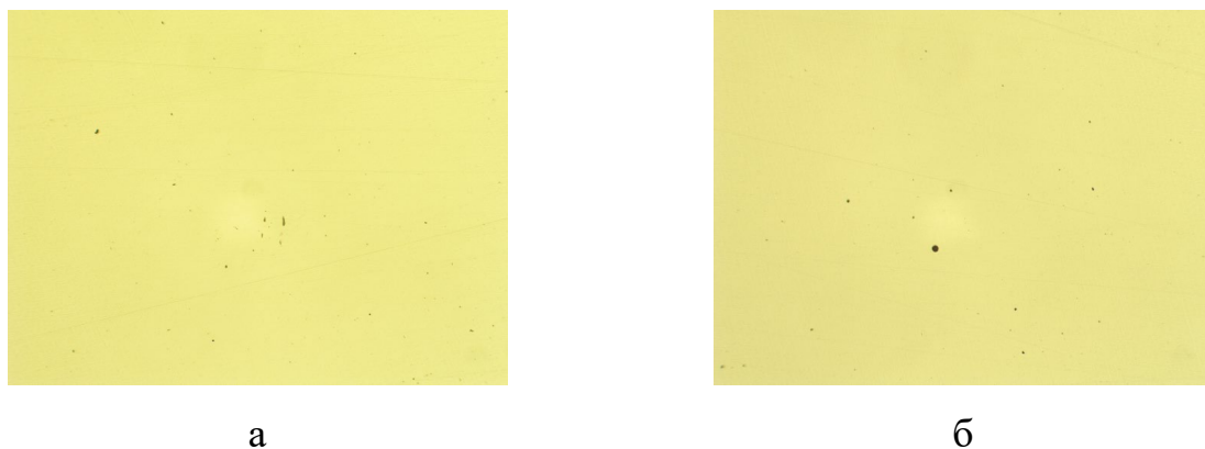
Рисунок 1. Аналіз неметалевих вкраплень ободу залізничного колеса ( \times 100 )
