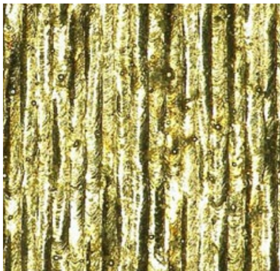
Коефіцієнт перекриття 30% (відстань сканування 0,07 мм)
